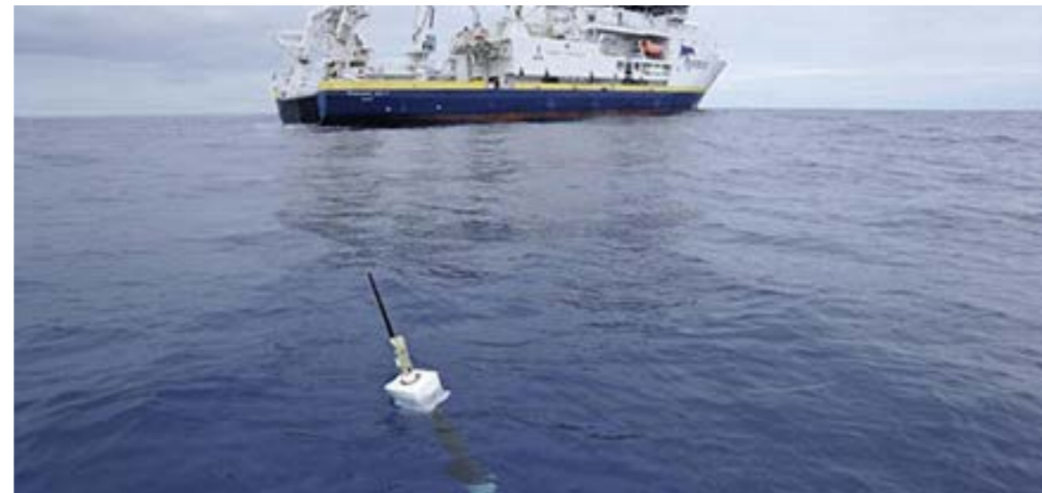
Flotadores Argo recogen la temperatura, salinidad y datos de velocidad
